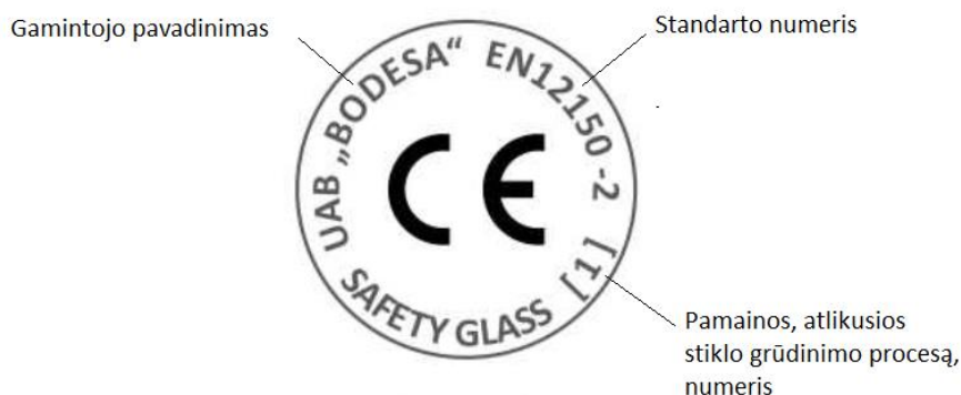
25 pav. Termiškai grūdinto saugaus kalcio natrio silikatinio stiklo žymėjimas.
